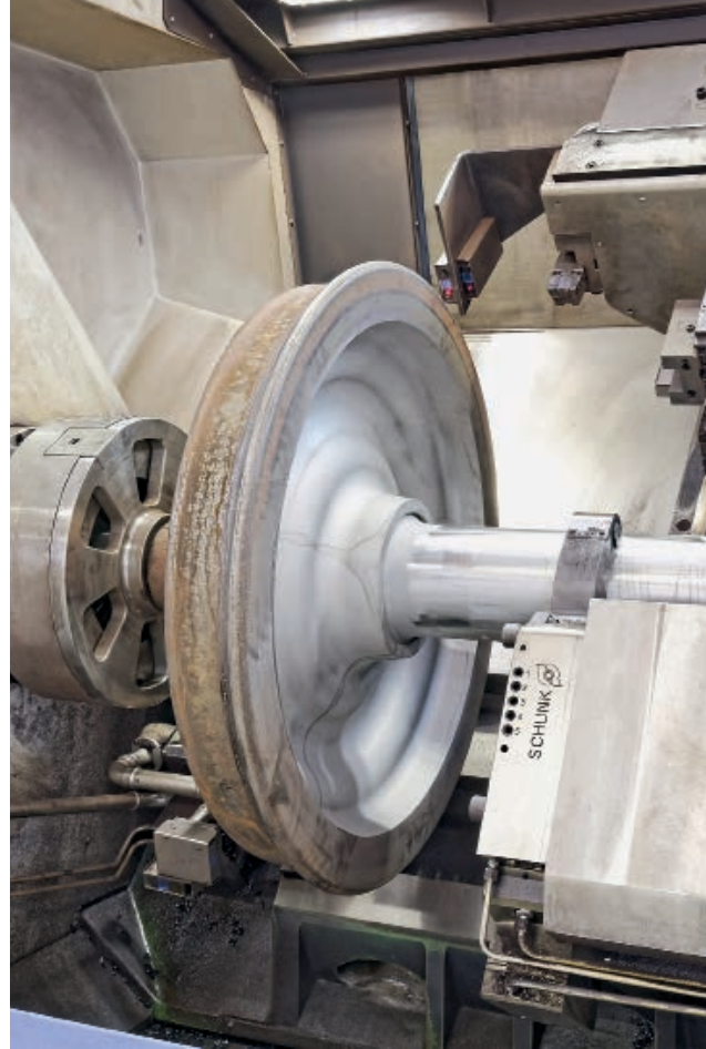
Per Laser wird jeder Radsatz zunächst vermessen. Anschließend ermittelt die von Wappler Werkzeugmaschinen entwickelte Software die jeweilige Bearbeitungsstrategie.
