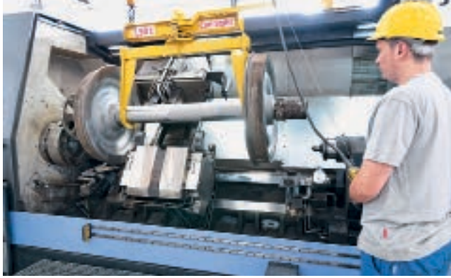
Die Beladung der Maschine erfolgt von oben. Jeder Radsatz verfügt über eine Zentrierbohrung, in der die unterschiedlichen Wellen mithilfe der hydraulischen Spitze gespannt werden.
